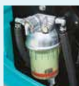
Prefiltro de combustible con separador de agua integrado
